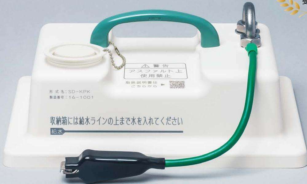
可搬形接地電極「かっぱーくん」は、本体箱の中に充填した保湿材をコンクリート内に浸透させることにより、簡易接地電極として使用できる製品です。高所作業車や重機の感電防止用接地あるいは接地抵抗測定時の補助電極として使用でき、安定した接地抵抗を容易に実現します。
