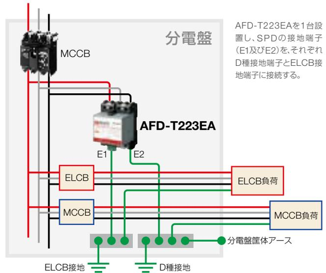
AFD-T223EAを1台設置し、SPDの接地端子(E1及びE2)を、それぞれD種接地端子とELCB接地端子に接続する。
