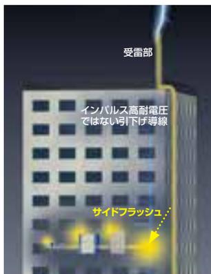
最近のビルなどにおいては受雷部の引下げ導線として、鉄筋、鉄骨などの金属部分を代用することが認められており (JIS A4201)、高建築物では引下げ導線を使用しない場合があります。また、建築物から引下げ導線を絶縁して使用する場合、雷電流が流れることによって発生する誘導電圧により、引下げ導線と建築物間の空気絶縁が破壊 (サイドフラッシュ) する場合があります。
