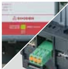
警報接点は警報接点端子（ALM）より出力し、c-a間はa接点出力（正常時：OPEN、異常時：CLOSE）、b-c間はb接点出力（正常時：CLOSE、異常時：OPEN）です。電気式の警報接点のメリットは、SPD故障時の発報はもちろん、SPDプラグの未装着で、警報接点出力を行います。そのため、万が一のSPD未実装など、SPDの過電圧制限機能が発揮できない状態を遠隔監視できます。尚、上記機能はSPDに電圧が印加されない状態（停電時）でも警報接点出力が行われますので、停電作業時に生じるSPDからの警報接点出力が不要な場合は、停電作業時にSPDからの警報接点出力を無効とする回路を付加するなどを推奨します。
