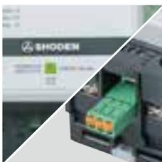
警報接点は警報接点端子(ALM)より出力し、c-a間はa接点出力(正常時:OPEN、異常時:CLOSE)、b-c間はb接点出力(正常時:CLOSE、異常時:OPEN)です。電気式の警報接点のメリットは、SPD故障時の発報はもちろんSPD分離器の動作、SPD分離器(ヒューズ)の未実装で、警報接点出力を行います。そのため、万が一のSPD分離器の動作やヒューズ未実装など、SPDの過電圧制限機能が発揮できない状態を回避できます。
