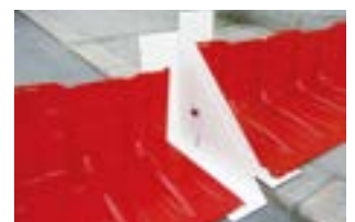
段差用アタッチメントを使った接続
